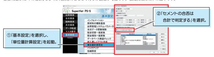
「セメントの合否は合計で判定する」が ON の場合、計量印字記録と単位量一覧でセメントの合否は 2 本合計で判定し、OFF の場合、個別で合否判定をします。
